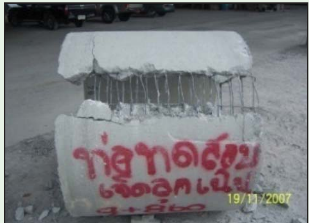
รูปที่ 5-6 การทดสอบท่อโดยการบีบอัดด้วยเครื่อง และตรวจสอบการเสริมเหล็ก
