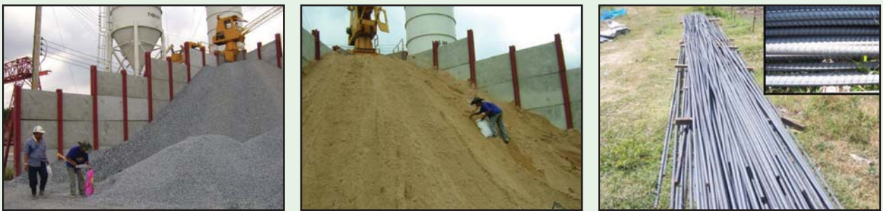
รูปที่ 5-18 การเก็บตัวอย่างวัสดุเพื่อทำการทดสอบ
