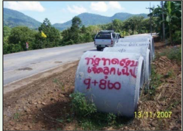
รูปที่ 5-5 ทำเครื่องหมายบนท่อที่สุ่มเก็บตัวอย่างเพื่อทดสอบ
