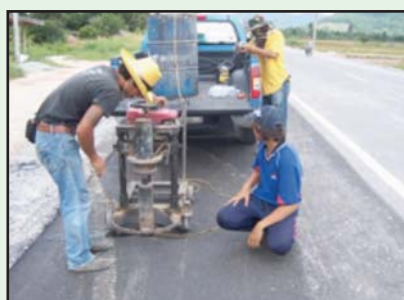
รูปที่ 6-38 การตรวจสอบคุณภาพชั้นผิวทางแอสฟัลต์คอนกรีต
