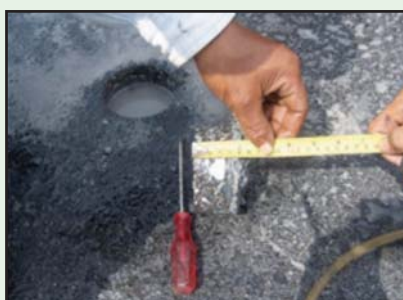
รูปที่ 6-38 การตรวจสอบคุณภาพชั้นผิวทางแอสฟัลต์คอนกรีต
